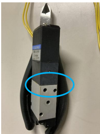
図 5 2 方弁 3SV のエアー漏れ箇所
