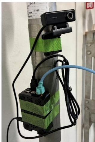
図3 回収圧縮機用アナログメーターのモニタを担当するラズパイ（raspi-cam002）
