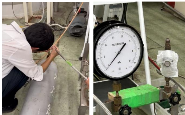
図1 検査台準備（高圧ガス接続時） および安全弁作動検査の様子
