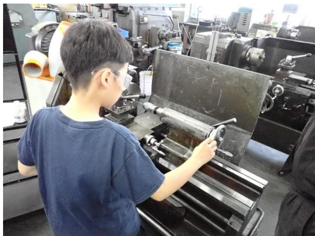
図4 旋盤で貫通穴加工をしている様子
