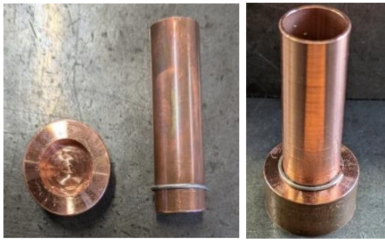
図6 ろう付け段取り様子
