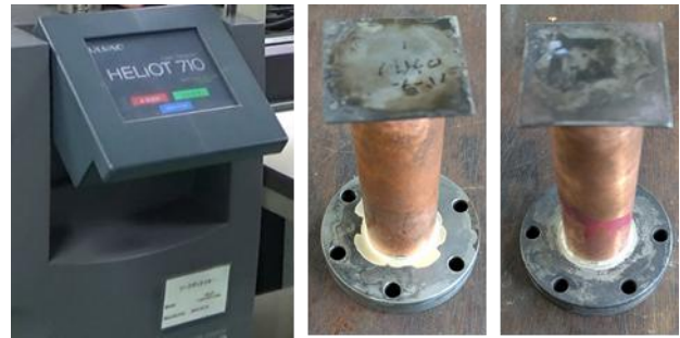
図15 ディテクター及び真空試験体 (左：バーナー，右：電気炉)
