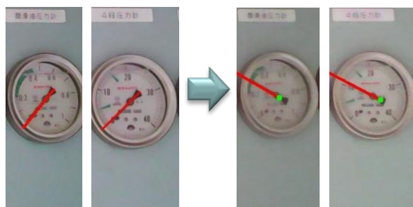
図5 OpenCVのPythonスクリプト実行結果（左：回収圧縮機オフ時、右：オン時）
