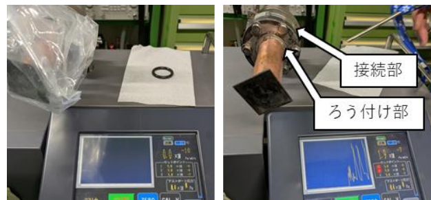
図16 リークテスト結果 (左：バーナー，右：電気炉)
