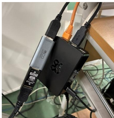
図 2 液化機制御 PC の画面入力を担当するラズパイ (raspi-cam001)
