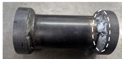
(b) 肉盛溶接による補修
