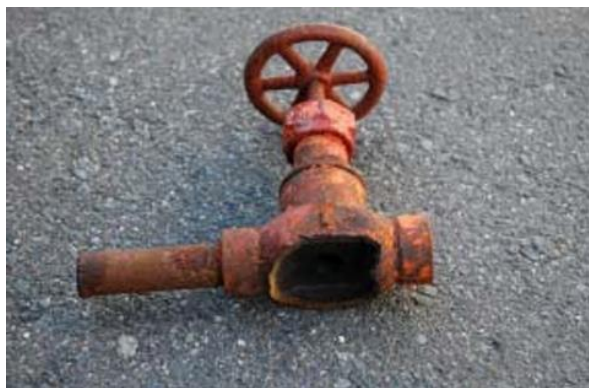
図1 破損した吐出弁
