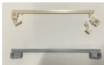
図 7. GHS 基板支持用樹脂部品の試作 (上：従来品，下：3D プリンタ試作品)
