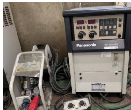
図1 CO 2 /MAG 溶接機 YD-350GR3
