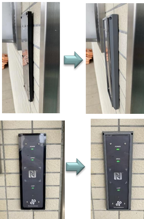
図 6. ICEEMS-C 筐体の試作 (左：現行の C 筐体，右：3D プリンタ試作品)
