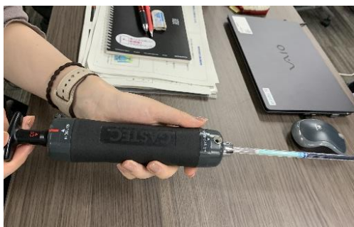
図1 ガス検知管の測定例
