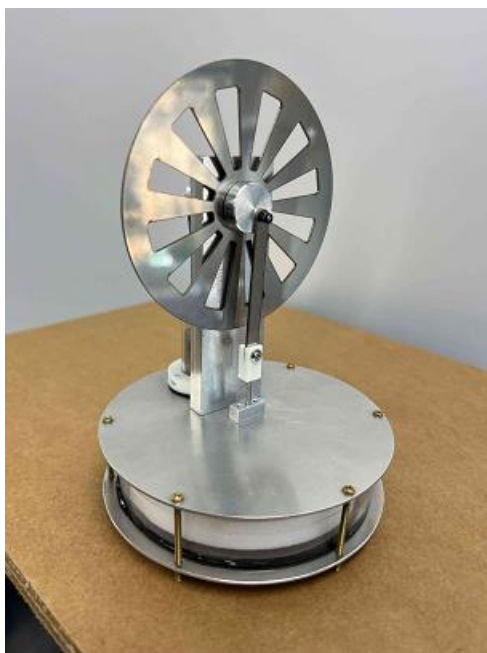
図 1 製作するスターリングエンジン
