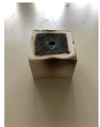
図 14 段階的昇温の鑄型
