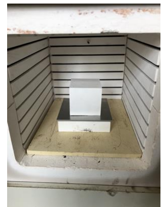
図 12 炉内に鑄型を設置
