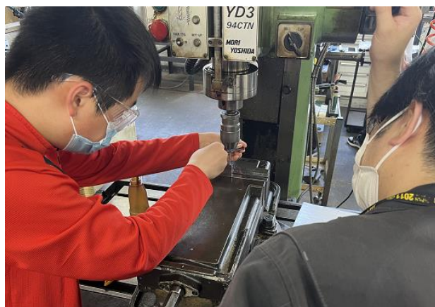
図 3 ボール盤でネジ穴加工している様子
