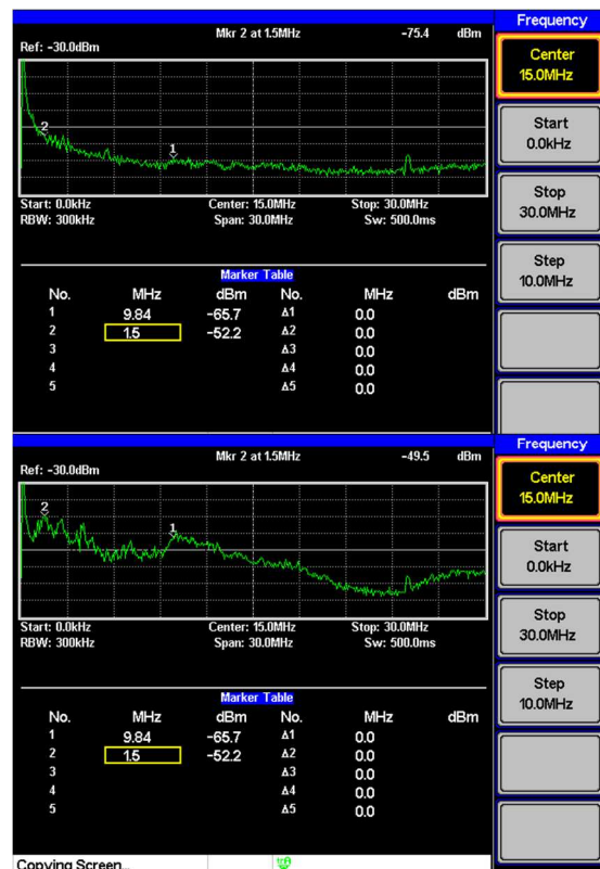
図 14. 古い冷蔵庫の雑音端子電圧 (上が電源 Off, 下が動作中, 中心は 15 MHz)
