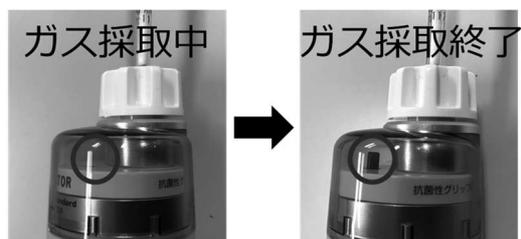
Fig. 5. ガス採取器のフローインジケータ
