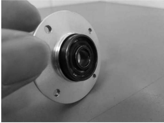
図3 ベアリング組み込み
