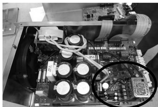
図6 循環ポンプ制御電源 対策前後のブロック図<sup>[2]</sup>と外観
