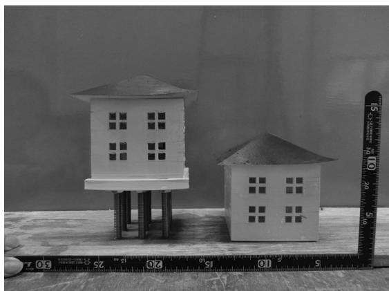
写真2 杭基礎とべた基礎の住宅模型
