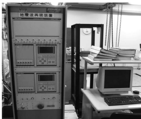
写真4 地震波再現装置の外観
