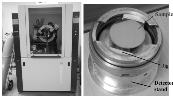
図2 XRD装置、並びに測定試料の外観
